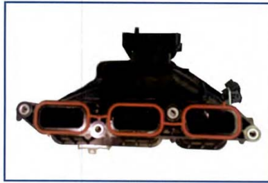
C11-2 Collettore di aspirazione - smontato Intake manifold - dismounted
