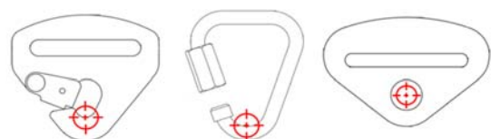
Příklady rotačních bodů ukotvení pásu Examples of pivot points of the anchorage of the strap
