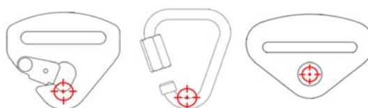
Příklady otočných bodů uchycení popruhu Examples of pivot points of the anchorage of the strap
