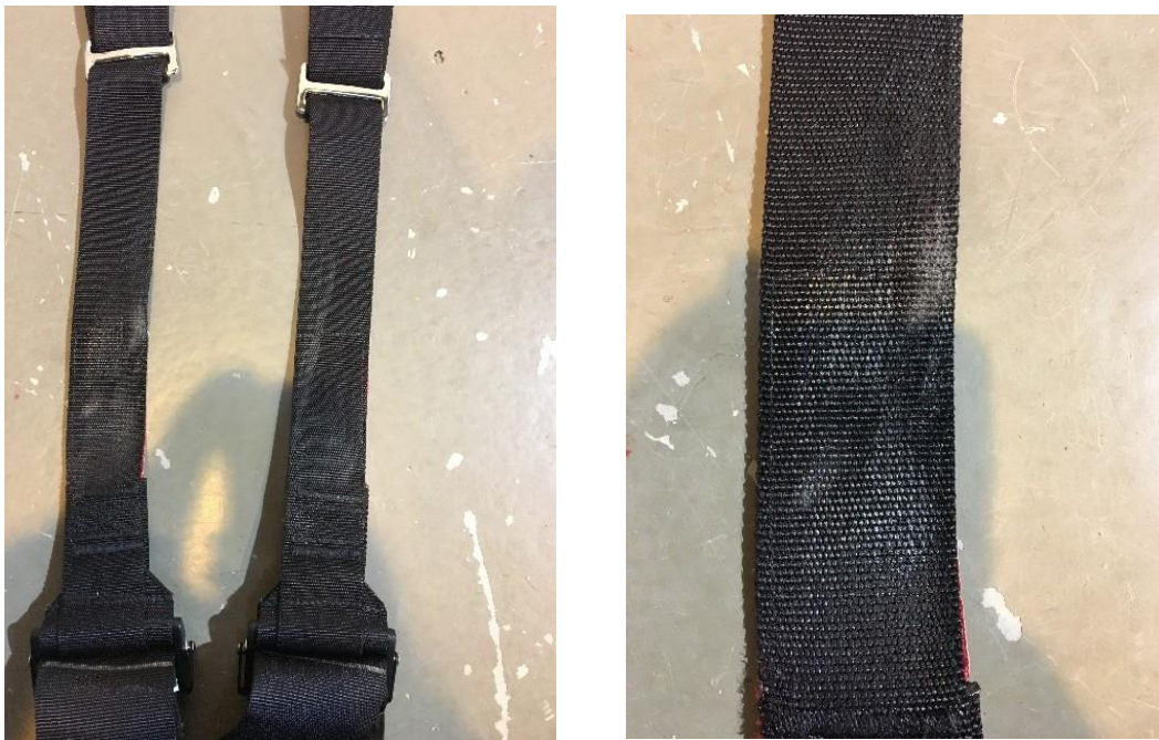
Obr. 3 – Natažené BP = musí být vyměněny
