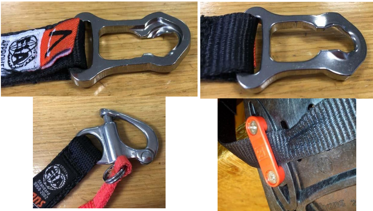
Obr. 1 – Deformovaná koncový úchyt pásku (nahore vpravo a vlevo, vlevo dole) a natažený pásek (řemínek) FHR (vpravo dole)
